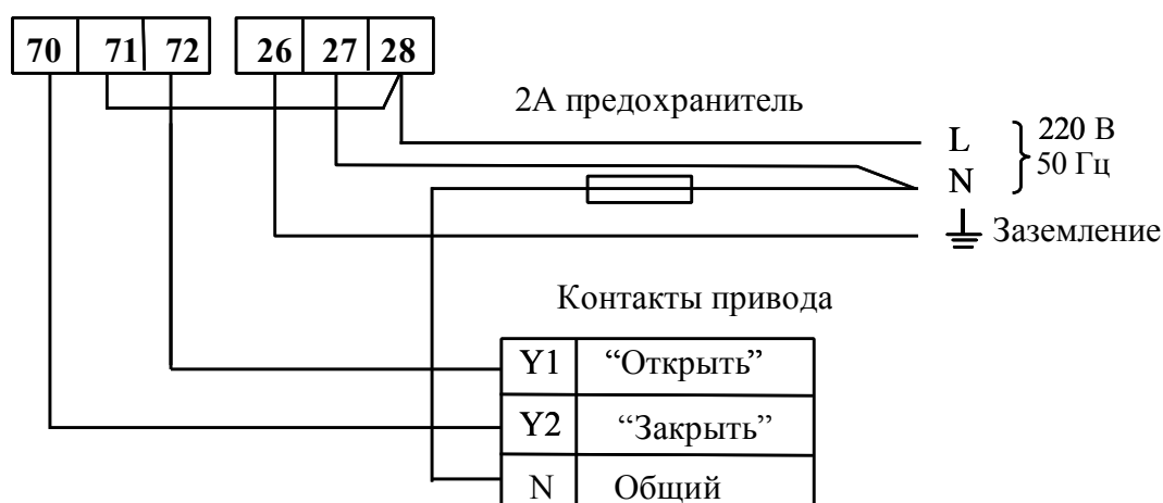
Рис Л.1. Схема подключения питания счетчика и регулируемой задвижки к модулю питания (напряжение управления задвижки 230 В)
