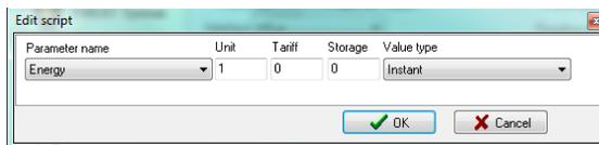
где можно изменять параметры название сценария - „Parameter name“, „Unit“ – номер параметра (pvz.: E1, E2, E3), тариф параметра – „Tariff“, признак архива – „Storage“, параметр качества – „Value type“ (обычная значение, min, max, or ошибка). Но эти параметры должны соответствовать параметрам считанным с прибора учета. По этому, когда вы выбираете прибор учета, прибор выставляет оптимальный список параметров для каждого прибора учета.
