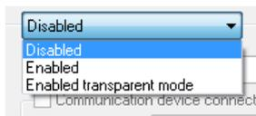
Если используется GPRS связь, этот канал для других целей не может быть использован. Если используется только Ethernet связь, включив „Enable“, этот канал может использоваться для прозрачного канала с внешними устройствами. Свойство „Enable transparent mode“, позволяет другим клиентам, через RS-232 интерфейс, подключиться к внешним приборам, подключенным к каналам UART0, или UART1.
